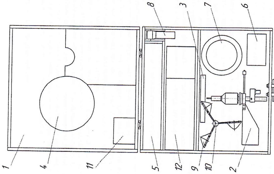
1 – футляр; 2 – датчик параметров ветра; 3 – термометр ТМ-8;
